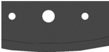
**3.** Positionner les vis sans tête M8 dans les trous de Ø8mm.
