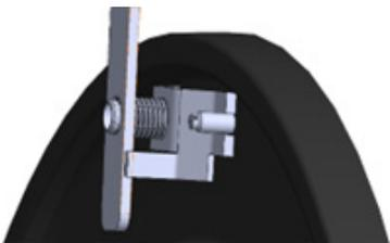
**5.** Visser les écrou M8 puis vérifier l'alignement lors de la mise en place des écrous
