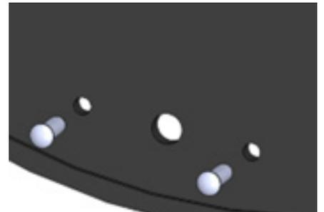
**4.** Régler le positionnement du kit pour que la vis soit centrée. Vérifier par-dessus que la vis soit bien positionnée.
