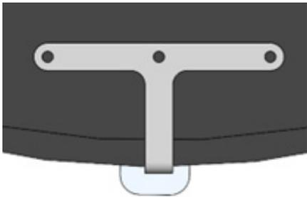
**2.** Percer les trous. Ceux aux extrémités sont à percer aux Ø8mm celui central au Ø14mm.
